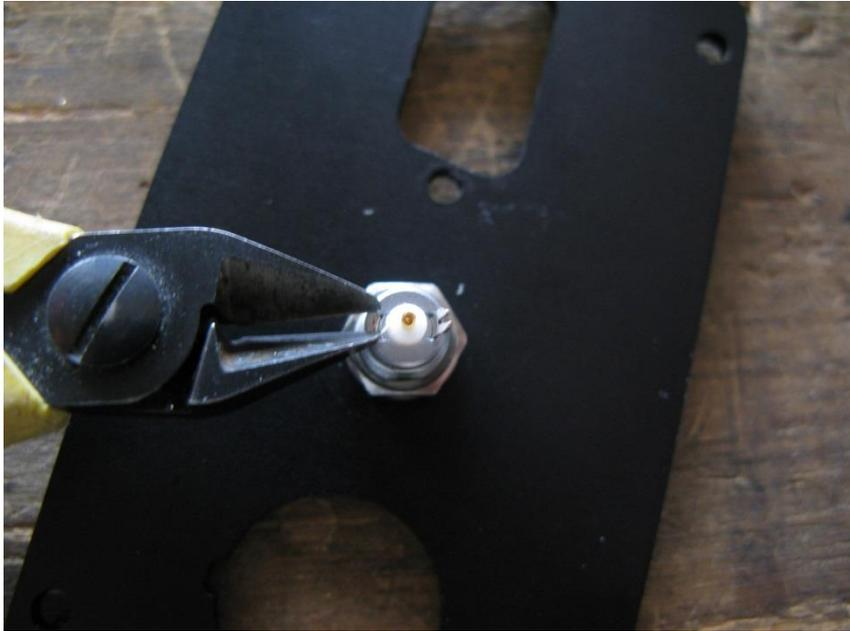
Eine der Massefedern mit Hilfe des Seitenschneiders entfernen
