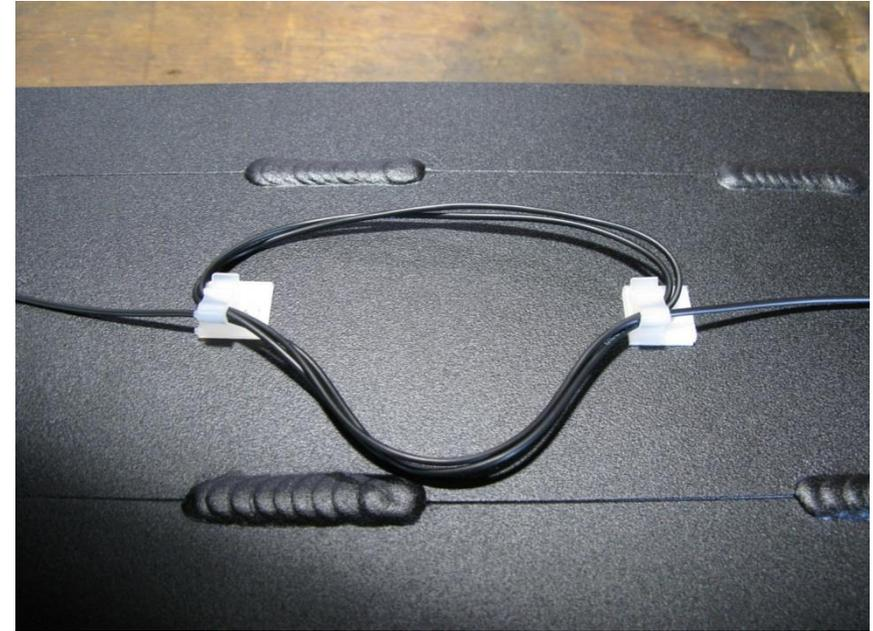
Die überflüssige Leitung in eine Schleife legen und mit Hilfe der Kabelschellen befestigen
