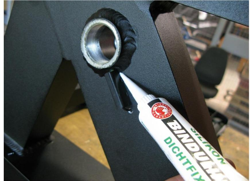
Anschließend das Gehäuse mit Silikon ummanteln
