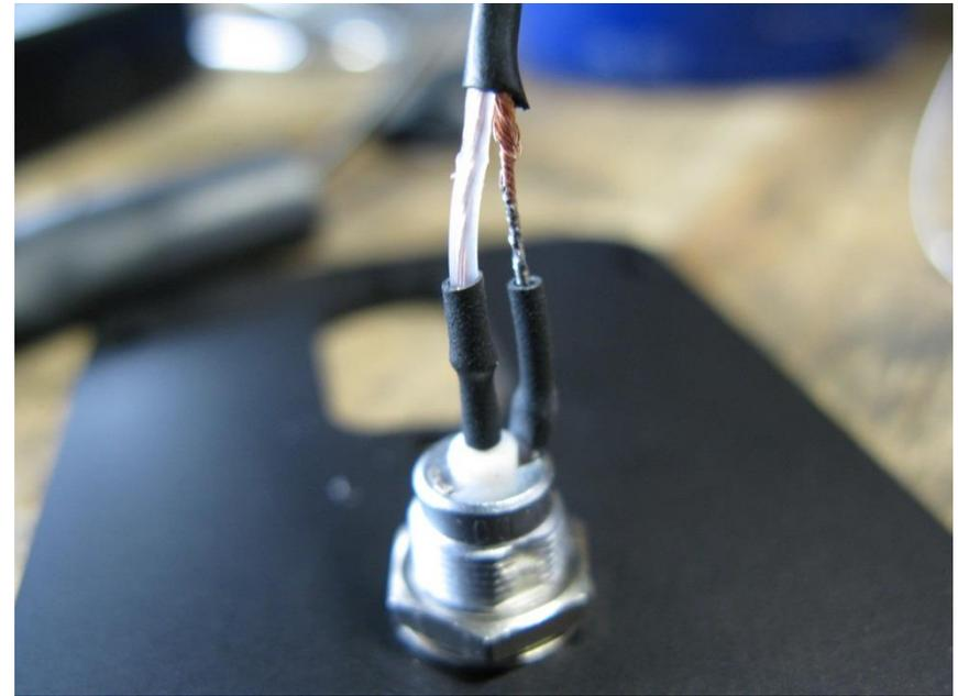
Den zweiten Schrumpfschlauch schrumpfen
