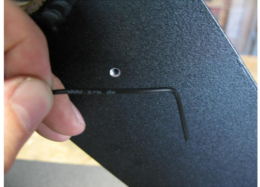
Das Kabel zum Einführen knicken
