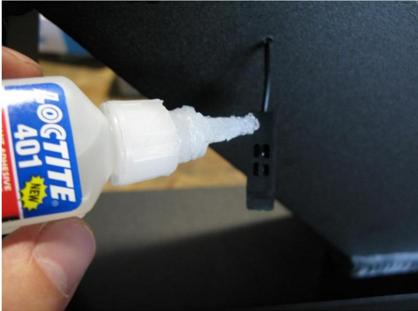
Den Boden des Gehäuses mit Sekundenkleber bestreichen
