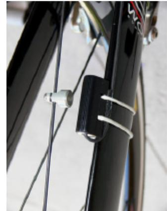
Befestigen Sie den Halter für den Geschwindigkeitssensor mit dem Gummiring oder Kabelbindern. Lassen Sie das Kabel des Sensors am besten unter dem Gummiring oder den Kabelbindern laufen. Klicken Sie den Sensor in die Halterung. Welches Ende wohin zeigt ist bei dem Geschwindigkeitssensor egal. Befestigen Sie den Speichenmagneten. Drehen Sie den Geschwindigkeitssensor so, dass der Abstand zum Magneten zwischen 1-3 mm beträgt.
