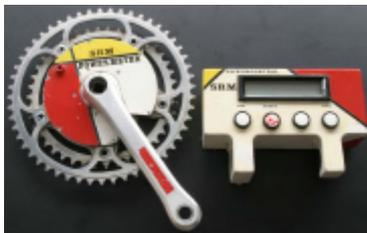
Die erste Version des SRM Training Systems funktionierte nach dem gleichen Baumuster wie die aktuelle Version, aber das PowerControl war nahezu genauso schwer wie der PowerMeter. Wenn Sie sich wundern, warum Ihr PowerControl ein "PC V" ist, dann müssen Sie wissen dass es die fünfte Generation des PowerControls ist. Links ein Bild vom ersten PowerControl.
