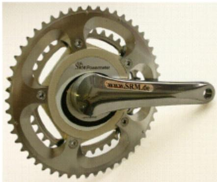
Öffnen Sie die Verschraubungen an der linken Kurbel und ziehen Sie die linke Kurbel ab. Sie können nun die rechte Kurbel mit der integrierten Achse aus dem Tretlager ziehen. Stecken Sie dann den Dura-Ace kompatiblen PowerMeter in das Tretlager und die linke Kurbel auf die Achse. Drücken Sie durch Zuschrauben der mitgelieferten Handschraube die linke Kurbel auf das Tretlager. Ziehen Sie die zwei Imbusschrauben der linken Kurbel stufenweise abwechselnd mit 12-15 Nm fest.
