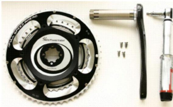
Der PowerMeter ist mit vier gleich großen Schrauben an der Kurbel befestigt.
