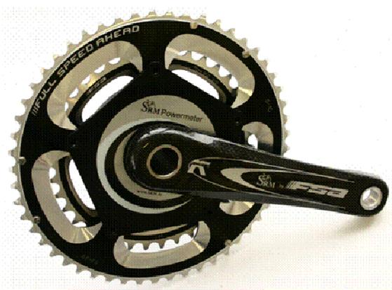
Bitte verwenden Sie nur das von uns mitgelieferte FSA Innenlager, bei anderen Innenlagern kann es zu Funktionsbeeinträchtigungen kommen. Stecken Sie den FSA PowerMeter genauso wie den Dura-Ace kompatiblen PowerMeter in das Tretlager. Geben Sie einen Tropfen Schraubenkleber in das Gewinde, stecken Sie die linke Kurbel auf die Achse, und ziehen Sie die Schraube mit 50 Nm fest.
