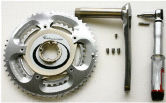
Der PowerMeter ist mit vier Schrauben an der Kurbel befestigt, wobei eine Schraube kleiner ist.
