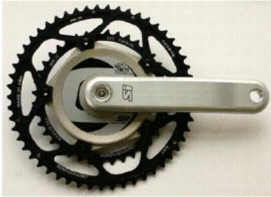
Stecken Sie die rechte Kurbel auf die Achse. Achten Sie darauf, dass die Verzahnung ineinander greift. Legen Sie nun die Unterlegscheibe unter die Kurbelschraube und ziehen Sie sie mit 38 Nm fest. Verfahren Sie mit der linken Kurbel genau so.
